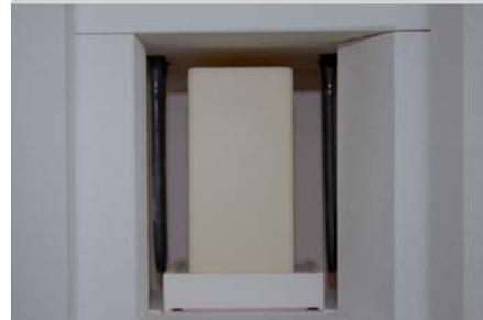
Déposer l'ensemble (support de cuisson+ pièce prothétique+capuchon) au centre de la chambre de cuisson.
