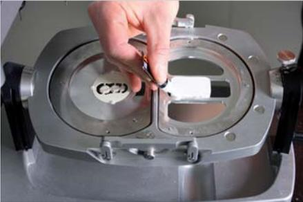
Fixer le bloc de zircone avec de la colle Attak Flex (gel) puis vaporiser l' Accelerator Spray sur celle-ci pour accélérer son durcissement.
