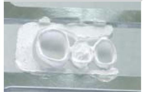
Le fraisage de la pièce prothétique est à présent terminé. Celle-ci va pouvoir être désolidarisée du reste du bloc de zircone.
