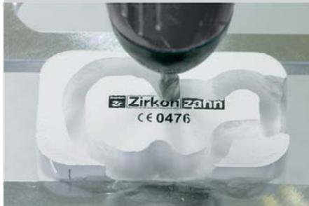
Commencer par fraiser l'extérieur du bridge, avec la fraise 4L.
