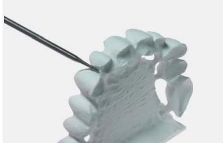
Vitesse maximale : pas plus de 10 000/tr car au-delà la zircone pourrait s'ébrécher.
