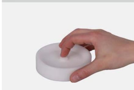
Retourner le moule et exercer une pression sur le téton de démoulage.
